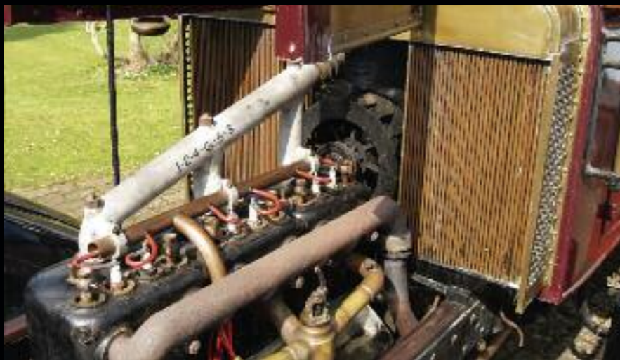
Den 6-sylindrede er støpt i 3 blokker.
