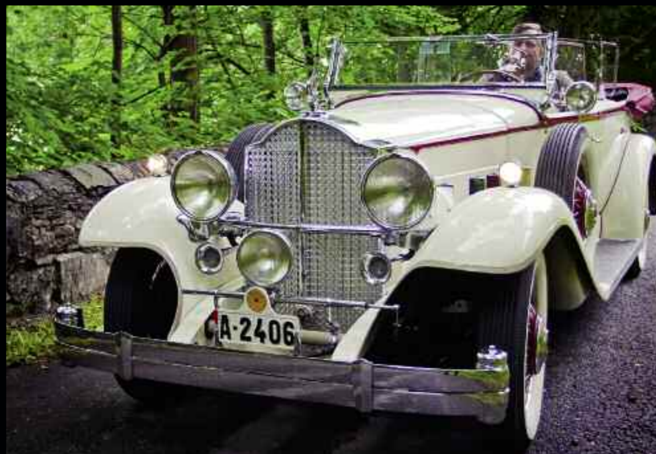
Frontlykten i midten svinger i takt med bilens rattutslag.
